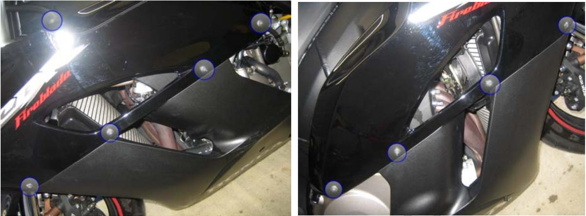
Von der Innenverkleidung die oberen beiden und seitlichen Kunststoffnippel lösen und die Befestigungsschrauben an den Lufteinlässen in der Kanzel entfernen. Die Seitenverkleidungen können nun nach hinten abgezogen werden. Die Blinker nun umbauen und wieder auf die Polung achten. Hier gilt wieder Orange ist links und Blau ist rechts.
