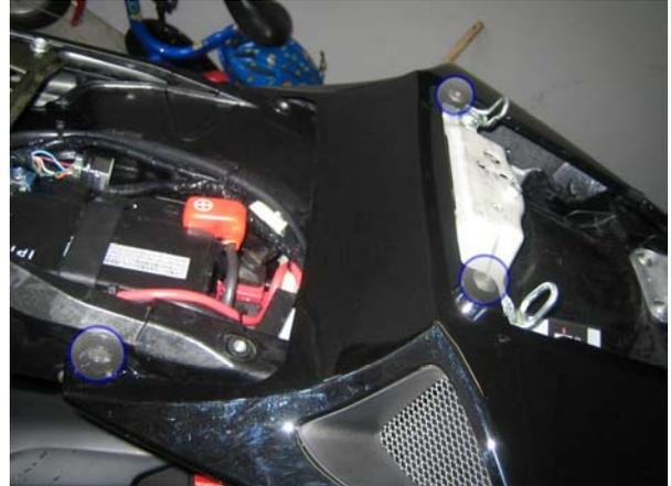
Nun werden die Originalblinker abmontiert und gegen schönere LED Blinker ersetzt. Wenn man sich vorab bei Polo, Blinker Adapterkabel beschafft muss man auch die Originalblinker kabel nicht abwickeln. Beim Anschluss von LED Blinkerkabel auf die richtige Polung achten da LED`s nur in eine Richtung funktionieren. Dabei ist zu beachten dass der blaue Stecker für die rechte Seite ist und der orangene Stecker für die linke Seite gehört.
